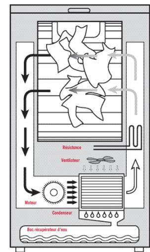
L'air chauffé absorbe l'humidité du linge.
