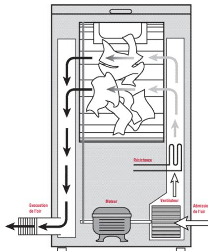
L'air chauffé absorbe l'humidité du linge.
