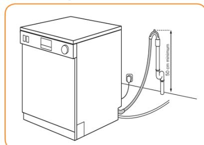
Hauteur minimale de la crosse 50 cm et maximale de 80 cm. Choisissez un tuyau d'évacuation de maximum 1,20 m.
