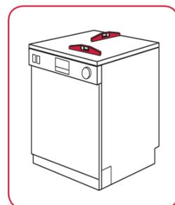
Ajustez le niveau avec les pieds réglables ou à l'aide de cales. Utilisez un niveau à bulle dans la longueur et la profondeur pour ce réglage.
